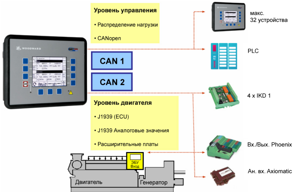
рис. 1-2. Обзор интерфейсов - интерфейсы CAN
