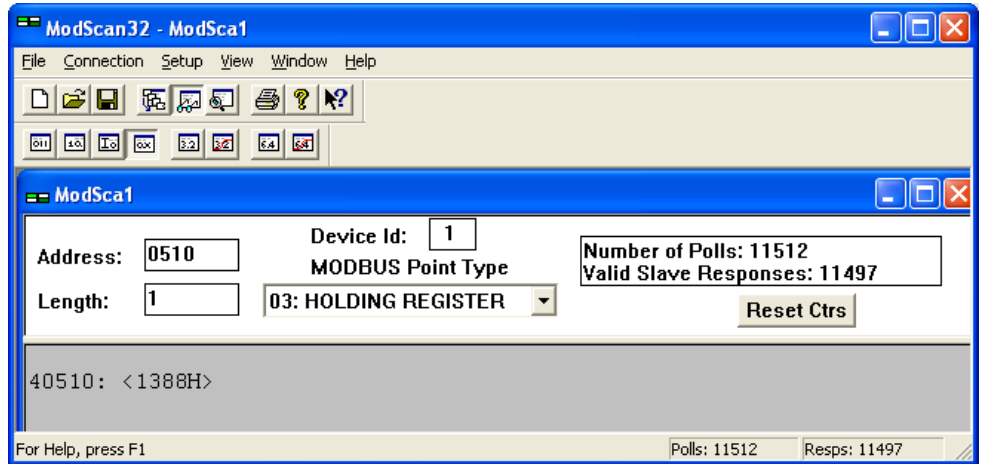
рис. 3-12. Modbus - пример конфигурации 4 - частота
