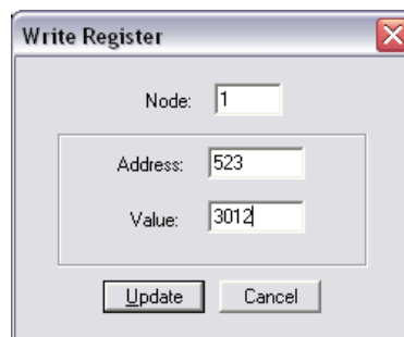
рис. 3-33. Modbus - регистр записи - подтверждение тревожного сообщения
