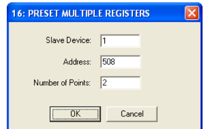
рис. 3-8. Modbus - пример конфигурации 4 - активная мощность
