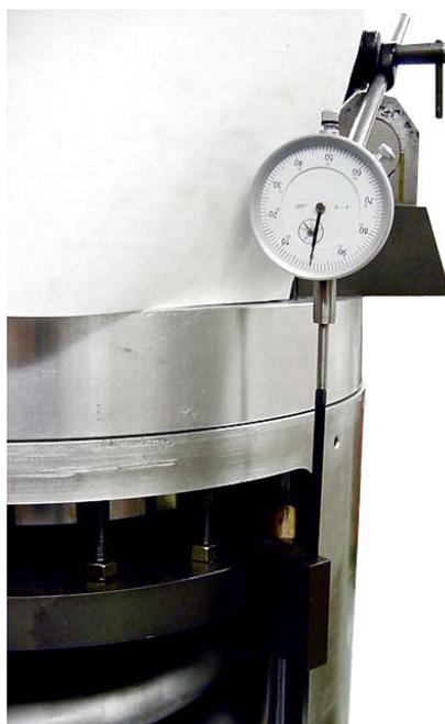
Рис. 5-1. Приспособление для измерения величины хода клапана
